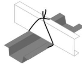
La Canaleta de Carga Estructural de marca NITCO es un perfil rolando en frío y fabricado con acero galvanizado anti-corrosivo.
